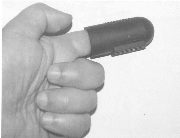
Este es el famoso "dedo de goma", utilizado para darle pala a la hélice sin lastimarse el dedo en caso de "patada" del motor. Para el mismo fin se puede utilizar cualquier trozo de manguera de goma.
