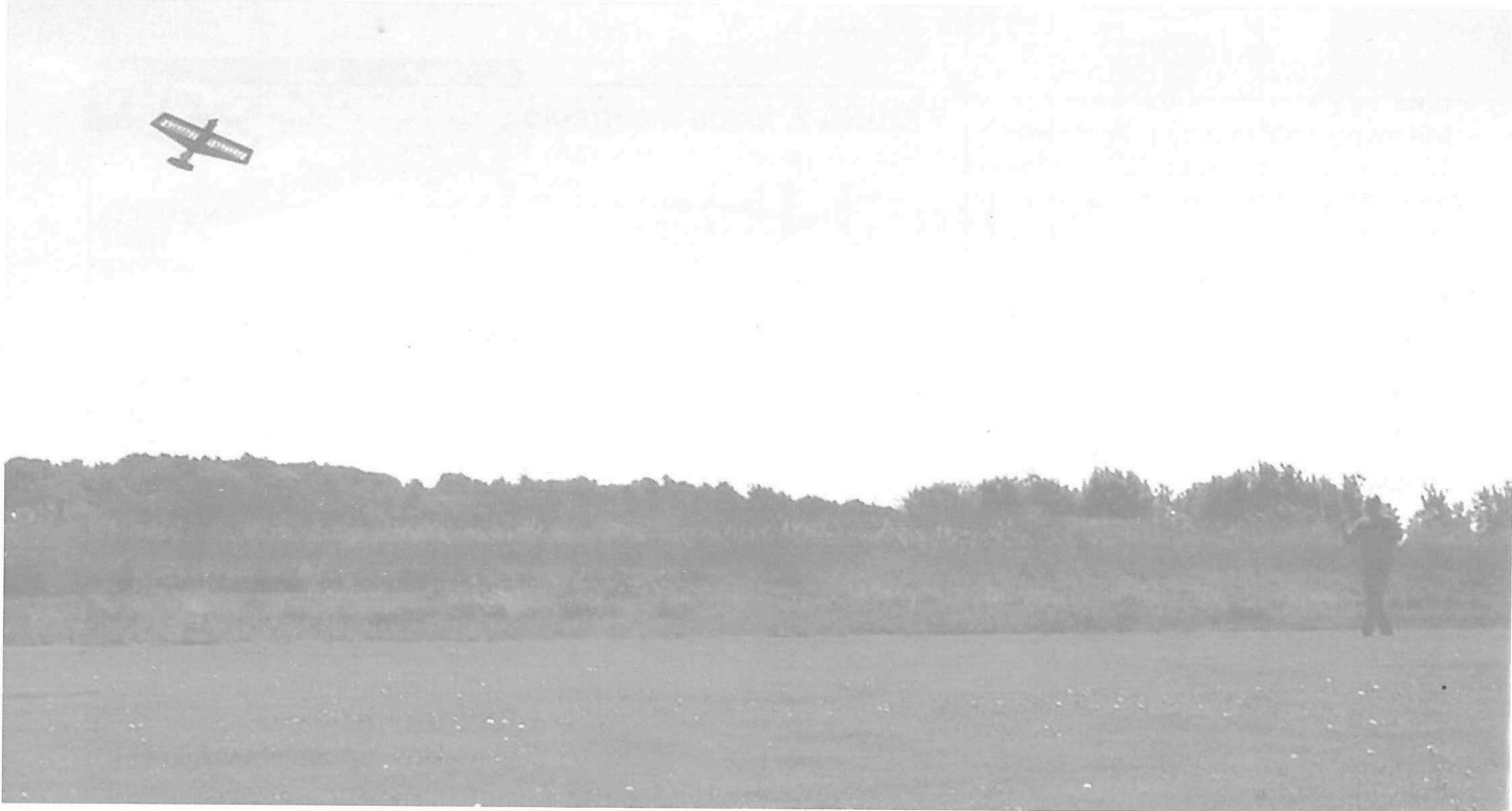
Ejecución del Looping con un modelo equipado con motor .15 y líneas de 15 metros de longitud.
