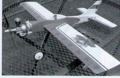
El kit del "Lil" Wizard" (de la firma estadounidense SIG) incluye un parallamas de terciado, y por delante del mismo una bancada "postiza" atada con bandas elásticas. En caso de estrellarse el modelo, el motor se desprende y no quiebra el fuselaje.
