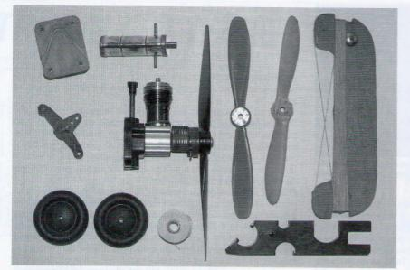
Alrededor de un motorcito *Cox .049*, se encuentran algunos elementos básicos necesarios para completar un "Tablita". Nótese abajo a la derecha la llave original de *Cox*, imprescindible para cambiar la bujía glow (nunca usar una pinza para realizar esa tarea).
