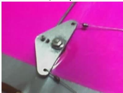
bien confeccionarlos fácilmente en aluminio, al igual que el pushrod (que también puede ser hecho en alambre de acero o bronce), para dejar el modelo en condiciones de vuelo. El cuerno se sujeta sin problemas mediante un tornillo 3/32" al movimiento del mando, y el balancín se sostiene con un tornillo 1/8" pasante (la tercer perforación en la costilla central).
