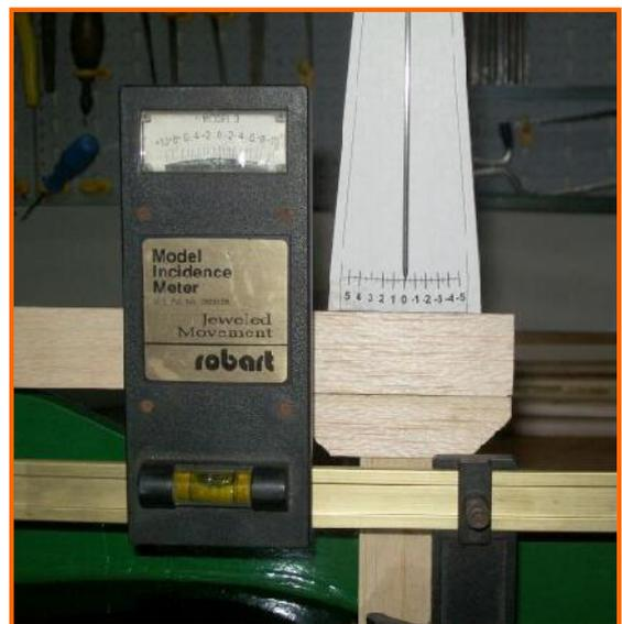
Además del medidor propuesto he confeccionado otro mucho más sencillo que uso para colocar sobre el timón de profundidad y, si se da el caso, sobre el lomo del fuselaje. La gráfica del medidor y la aguja son idénticas al que le muestro al principio de la nota.
