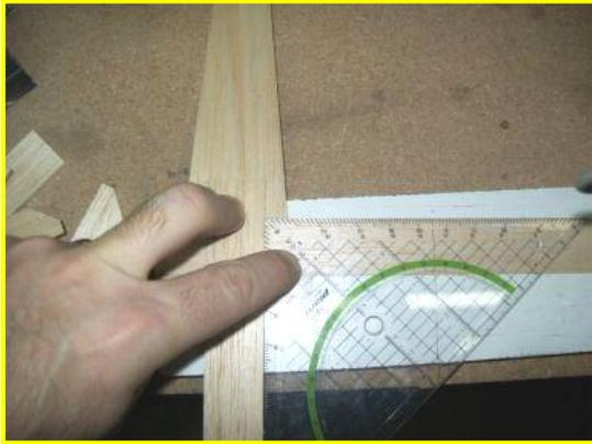
Ahora posicione –y sujete fuertemente- como se indica en el plano el fleje principal del instrumento, la parte que contiene la lámina y una de las mordazas. Cuando esté seguro de la alineación con unas gotas de cianocrilato inmortalice la unión de estas tres partes.
