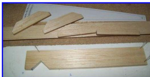
Pegue la lámina del instrumento a la madera teniendo la precaución de colocar la base justo sobre el borde de la madera. Realice la perforación donde irá el buje de la aguja, colóquelo y péguelo con un gotita de cianocrilato (Asegúrese que el bujecito está bien perpendicular a la madera). Utilicé un tubo de 3mm exterior de cobre, pero puede utilizar otro similar de bronce o un remache "pop" de 3x10mm.
