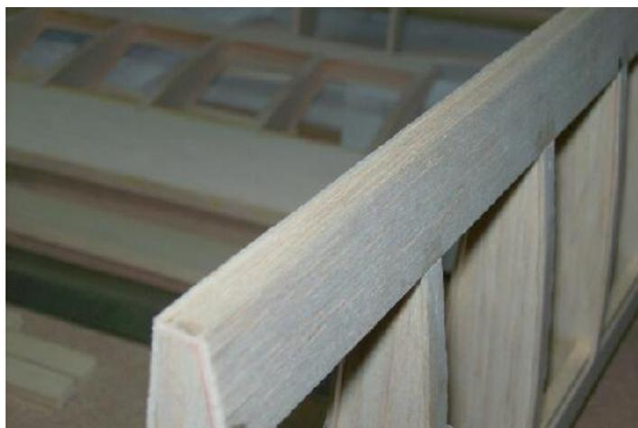
Foto superior: Borde de fuga listo para ser lijado
