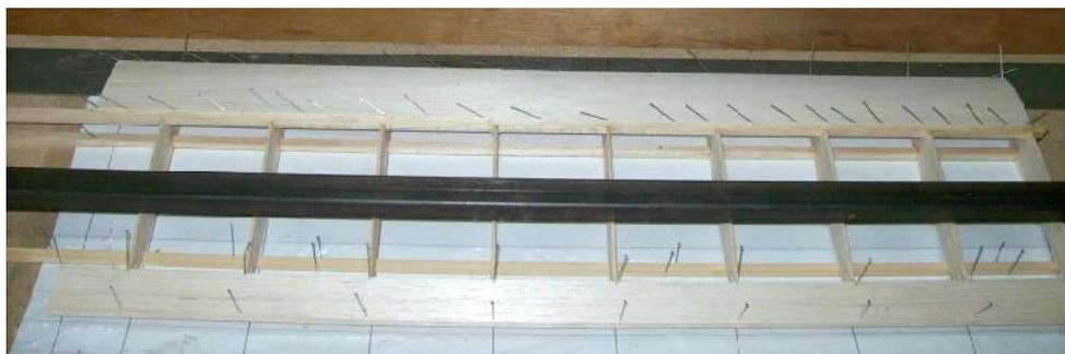
Ahora sí, es momento de retirar el caño de hierro para poder colocar los cap-strip y el enchapado de la parte central. Una vez que el pegamento ha secado retiramos todos los alfileres y lijamos suavemente las uniones del enchapado con los cap-strips para poder dar vuelta el ala. Hágalo ahora y repita la operación de enchapar borde a ataque, de fuga y colocación de los cap-strips.
