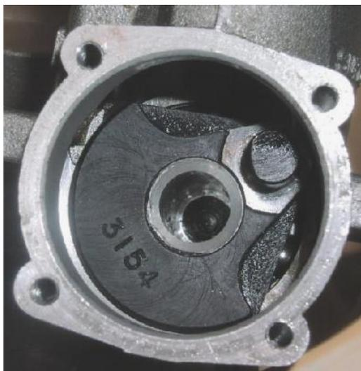
Para acelerar el pasaje de combustible dentro del cigüeñal puede reducirle el diámetro interior haciéndole un buje como el que le muestro en la siguiente foto. El diámetro final fue llevado a 8mm.
