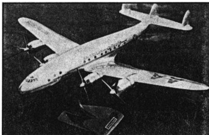
Más adelante colaboró con el equipo de diseño del Constellation, que en ese momento tenía una velocidad de crucero levemente inferior a la del DC-4 y el DC-6, y elaboró el modelo para probar en el túnel de viento las mejoras en la aerodinámica (específicamente las uniones de ala con fuselaje, motores con ala y timones con estabilizador) que lograron que el avión pasara a superar a sus competidores.
