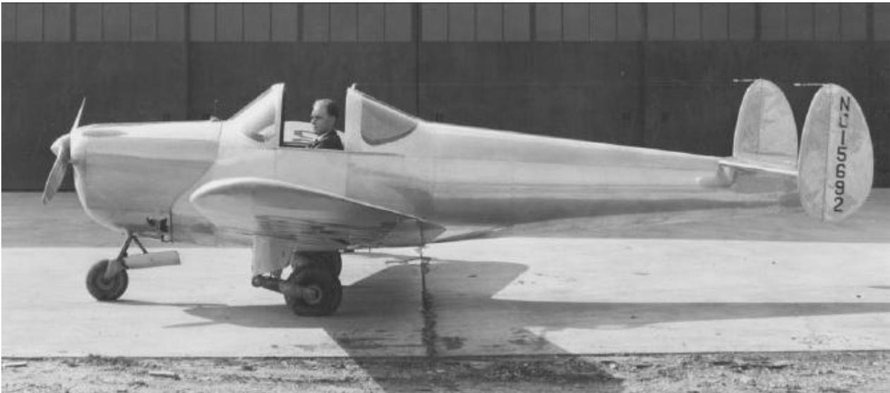
En esta ocasión (y otra vez sacado del baúl de los recuerdos) un modelo ala baja, con tren de aterrizaje fijo y doble deriva ilustra esta sección.
