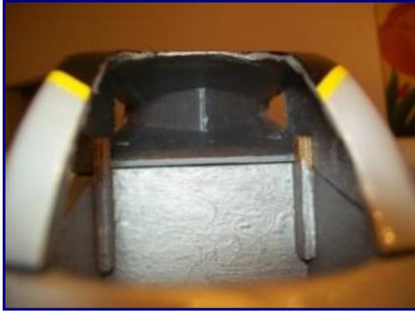
**Ventanas de refrigeración del motor.**
