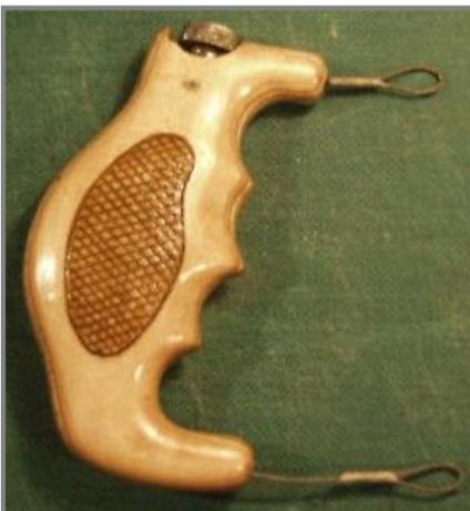
Los defensores de la INCLINADA dicen: En la manija con empuñadura sesgada existe una relajada posición de la mano del piloto durante el vuelo nivelado (Elevador y/o Flaps en neutral), donde las líneas son equidistantes del aeromodelo,
