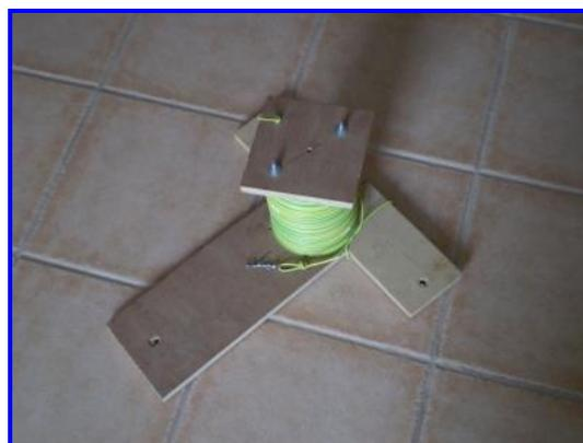
En las fotos que preceden se pueden ver los tientos de la línea de amarre en el cual uno de ellos es ajustable para regular el ángulo de inclinación de la máquina. En la otra foto se aprecia el carretel con su base hecha en terciado fenólico el cual se clava en el centro de la pista con, por ejemplo, clavos de generoso tamaño.
