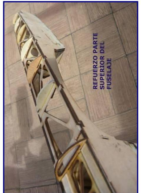
Otra foto del fuselaje de construcción mixta en balsa y terciado de álamo
